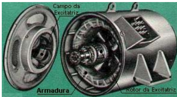
Estator e tampa com bobinas de campo da excitatriz. – Alternador NEGRINI
